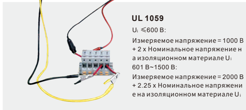
Испытание импульсным напряжением
