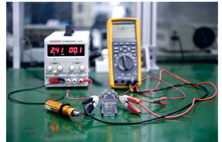
Испытание винтовых клемм на падение напряжения
