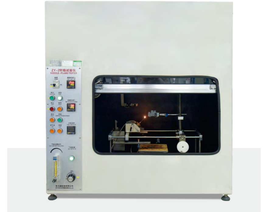
Устройство подачи точечного пламени
