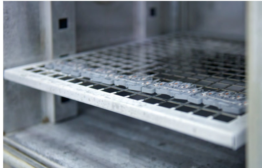
Циклические температурные испытания клемм на DIN-рейку
